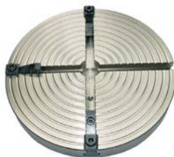
Поворотный стол с зажимным диском \varnothing 250 мм
